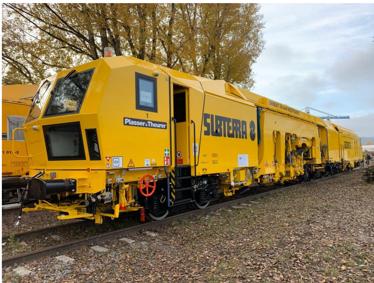
Obr. 2: Automatická strojní podbíječka 09-4x4/4S Dynamic
